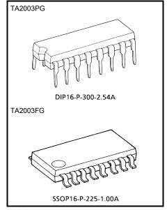
Weight DIP16-P-300-2.54A: 1.00g (typ.) SSOP16-P-225-1.00A: 0.14g (typ.)
