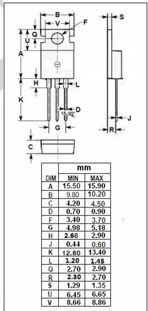
**isc N-Channel Mosfet Transistor****IRF632****ELECTRICAL CHARACTERISTICS** $T_c=25^\circ\text{C}$  unless otherwise specified
